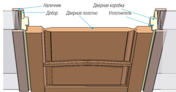
При толщине стены от 50 до 75 мм. возможен вариант сборки дверной коробки без добора, как показано на схеме:
