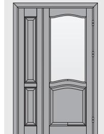
Мы используем только kleевые конструкции для внутреннего наполнения дверных полотен (см. рис) тем самым избегая деформаций и растрескивания изделий на протяжении всего срока эксплуатации.
